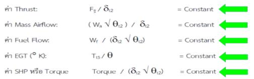
การวัด Thrust ( $F_s$ ) ขณะบินในอากาศไม่สามารถทำได้ เราจึงวัด Thrust ขณะทำการบินโดยใช้ค่า  $^{45}$  EPR (Engine Pressure Ratio) ซึ่งมีค่าเท่ากับ Total Pressure at Jet Nozzle Outlet / Total Compressor Inlet Pressure หรือวัดด้วยค่า N1 (Fan Speed) หรือ Compressor Speed ดังนั้น EPR /  $\delta_{t2}$  = Constant หรือ N1 /  $\sqrt{\theta_{t2}}$  = Constant ซึ่งเป็น parameter ในการทำ Engine Trend Monitoring (ETM) ให้กับ ย. Turbofan และ Turbojet
